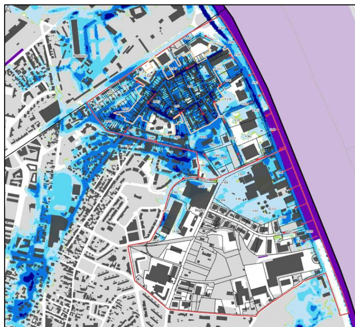
Hauteurs de submersion maximales (Scenario Défaillance généralisée)
